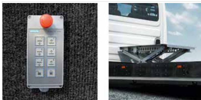
Commande manuelle dans la cabine du conducteur Plateforme élévatrice
