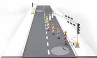
Controllo via radio in funzione del traffico
