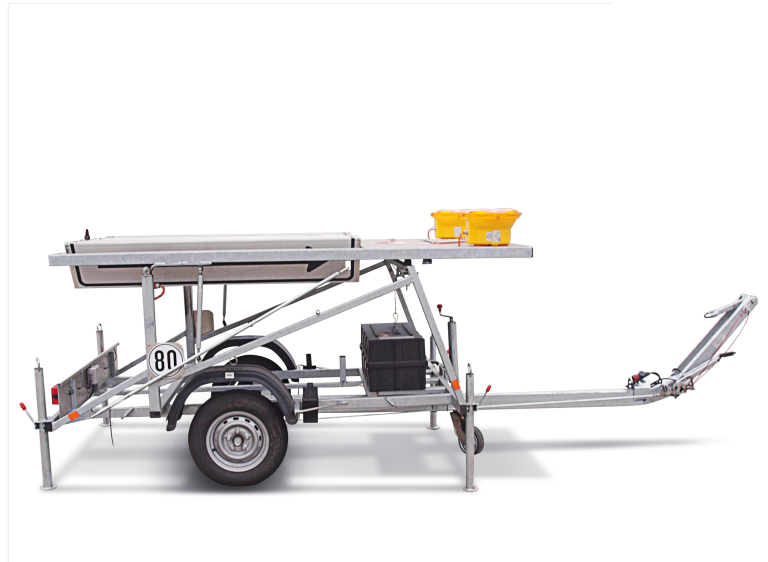
Fahrbare Vorwarntafel Typ VLT1 (Seitenansicht)
